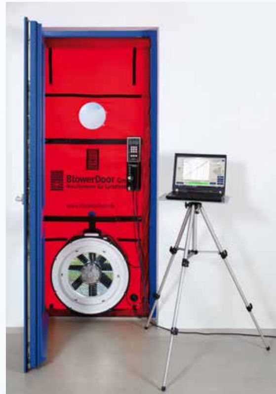
Markkinajohtaja: Minneapolis BlowerDoor, mittausalue 19–7200 m 3 /h
