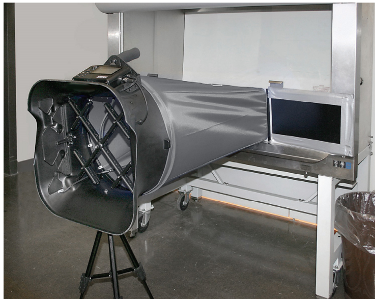
Kuva 20: Huppu ilmamäärän mittaamiseen
