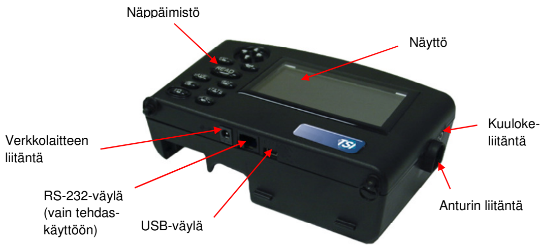
Kuva 1: 8715/8380 Paine-eromittarin osat, etunäkymä
