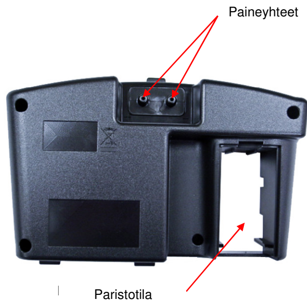
Kuva 2: 8715/8380 Paine-eromittarin osat, takanäkymä
