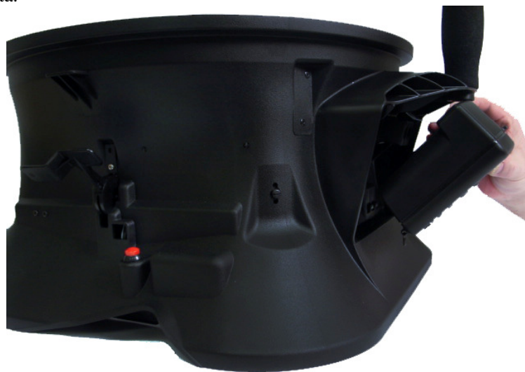
Kuva 8: Paine-eromittarin kiinnittäminen huppumittarin runkoon
