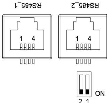
Fig. 3 RS485\_1 og RS485\_2: RS485\_1: Sokkel til kabel fra FLEX Fjernbetjeningsspanel RS485\_2: Sokkel til kabel fra Modbus.
