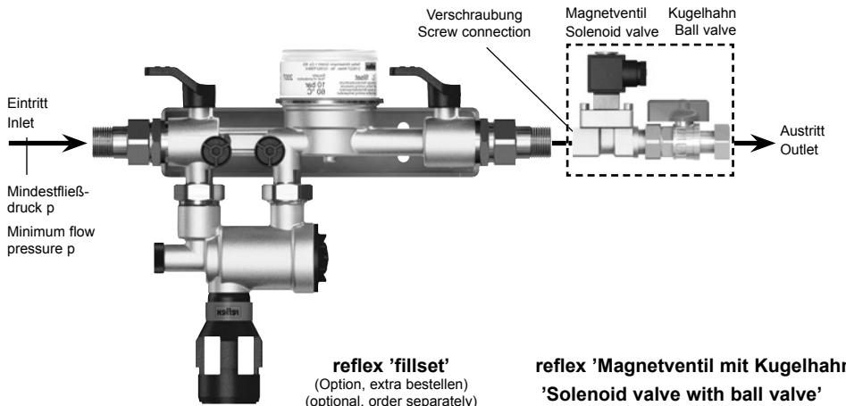
**reflex 'Magnetventil mit Kugelhahn'**
